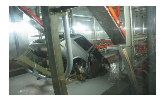
Рис. 2 Участок нанесения декоративно-защитных покрытий цеха окраски
